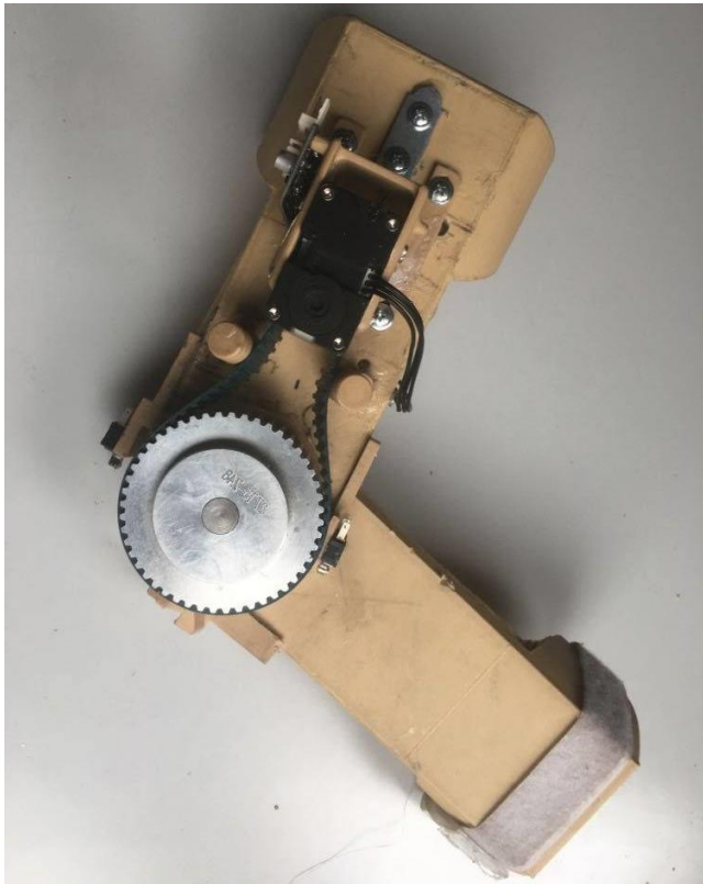
Фиг. 2. Прототип на ортезата с монтирани актуатор и редуктор
