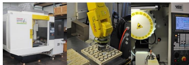
Фиг. 3. FANUC ROBO DRILL, Обслужващ робот поставя обработените детайли. Устройство за бърза смяна на инструментите с 21 инструментални позиции [4]
