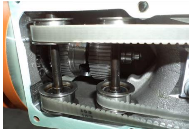
Фиг.10 4-та, 5-та и 6-та ос на индустриален робот [8]
