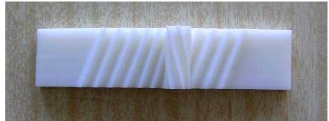
Фиг. 3. Механизъм с неравномерна стъпка и трансляция на изходното звено
