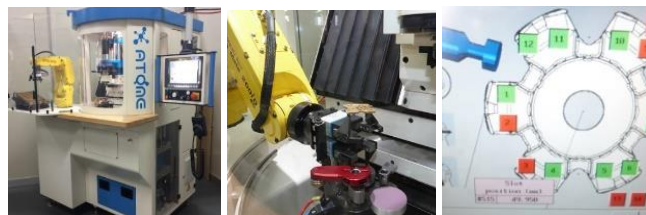
Фиг. 2. Робот FANUC LR Mate 200iD и напълно персонализиран интерфейс човек-машина обслужва центъра Атоме [3]
