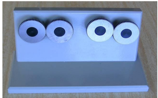
Фиг. 4. Ексцентрикова зъбна предавка, позволяваща получаването на синусоиден закон за движение на изходното звено
