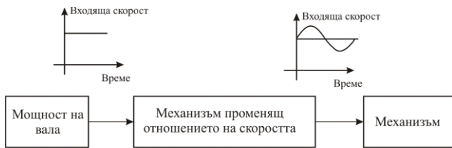
Фиг. 1. Механична система механизми с променлива скорост на задвижващия вал
