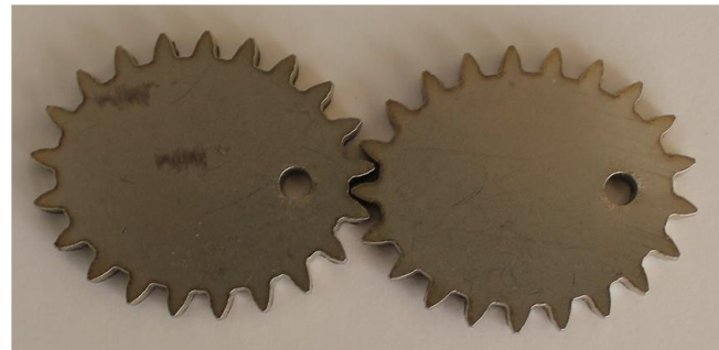
Фиг. 5. Елиптически зъбни козела с асиметричен профил на зъбите
