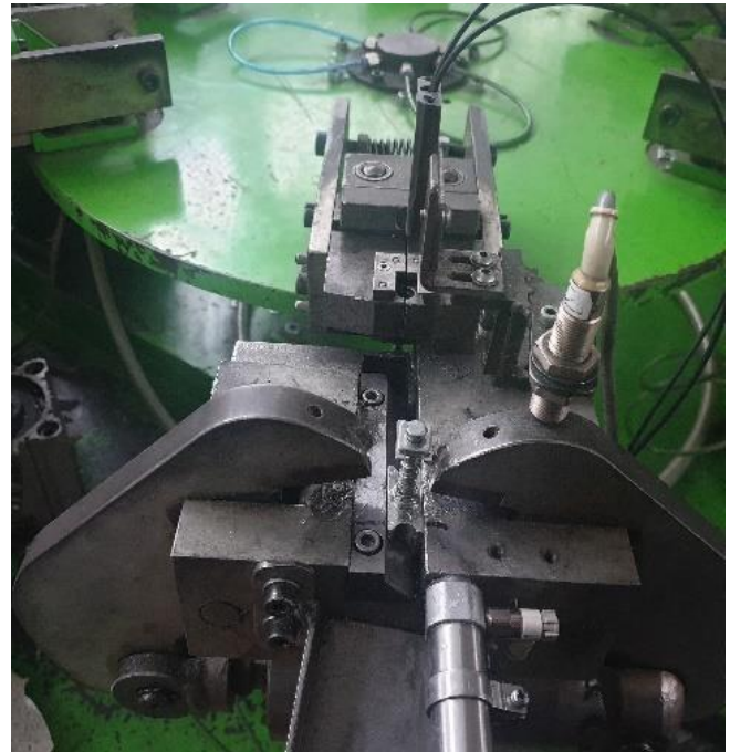
Фиг. 9. Станция 6. Занитване на горния език
