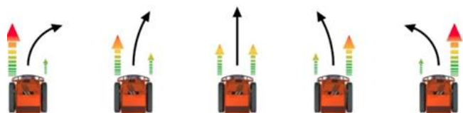
Фиг. 3. Принцип на диференциално задвижване на робоплатформа
