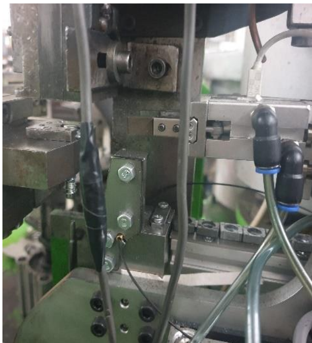
Фиг. 14. Пневматичен цилиндър с щипки
