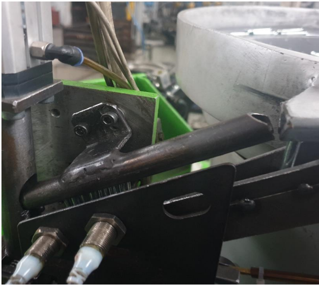
Фиг. 7. Станция 4. Поставяне на степенната ос
