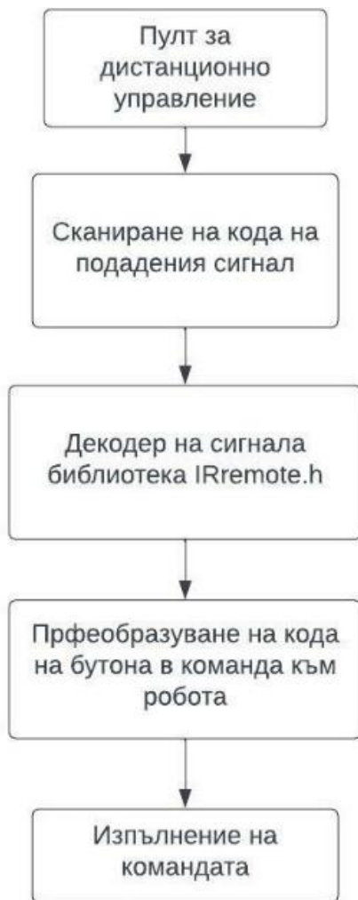
Фиг. 4. Общата блокова схема за телеуправление на робота посредством инфрачервен датчик
