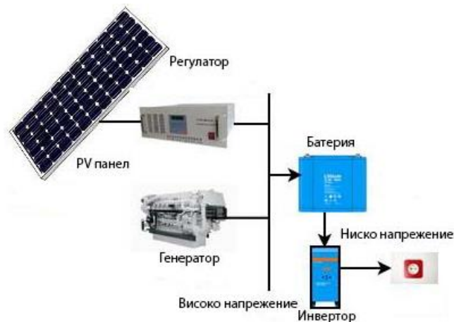
Фиг. 5. Соларно-дизелова/газова система
