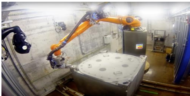
Фиг. 4. Промислен робот Kuka KR150 запечатва капака на контейнер с радиоактивни отпадъци [53]
