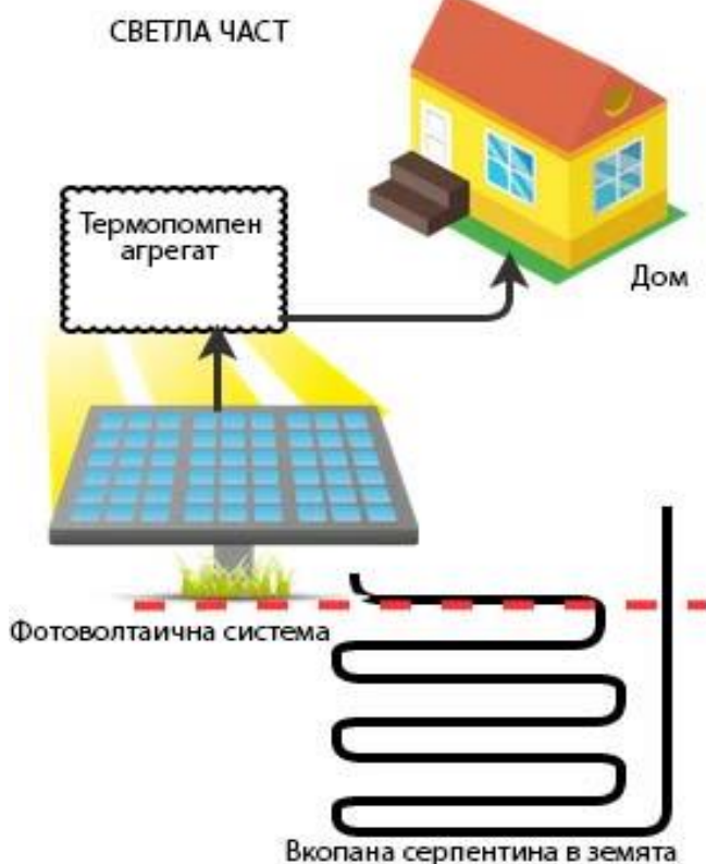
Фиг. 2. Слънчево-геотермална система при наличие на дневна светлина
