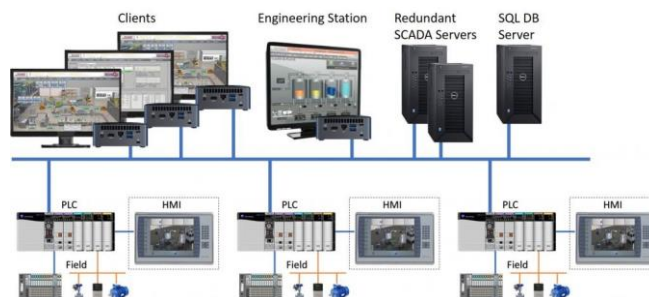
Фид. 3. Пример за архитектура на SCADA система
