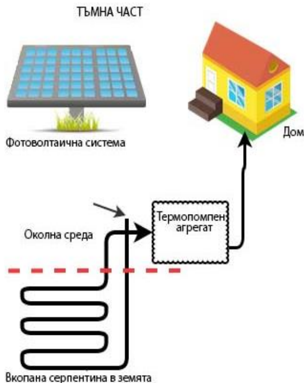
Фиг. 3. Слънчево-геотермална система без наличие на дневна светлина
