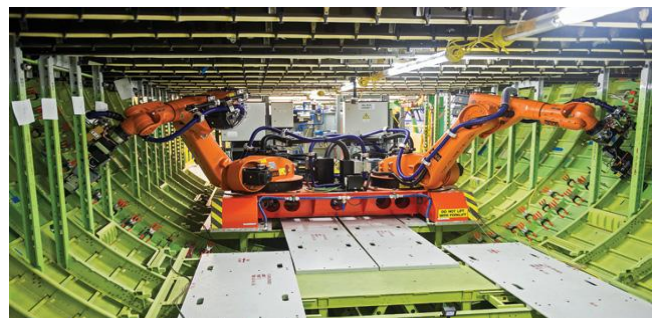
Фиг. 5. Система FAUB с промишлени роботи Kuka в завода на Боинг в Париж, Франция [74]
