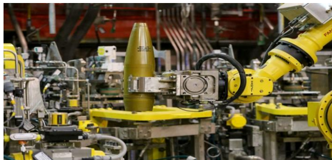
Фиг. 3. Утилизация на военен боеприпас в химическо военно депо Пуебло, Колорадо, САЩ [25, 26]
