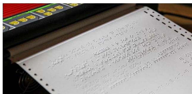
Фиг. 4. Брайлов принтер [10].
