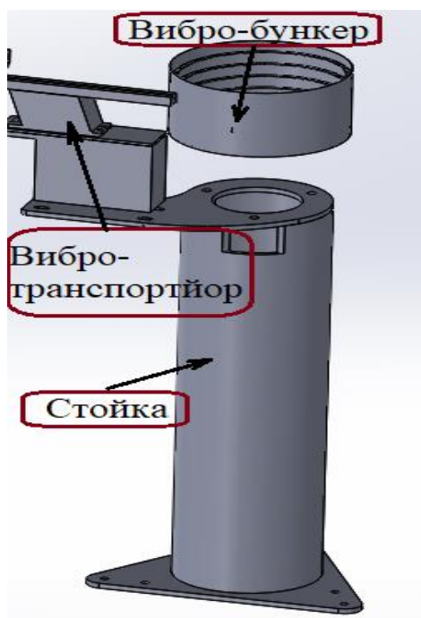
Фиг. 12. Заден възел на станция 7 - 3D
