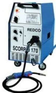
Фиг.2. Заваръчен апарат МИГ/МАГ [6]
