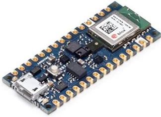
Фиг.14 Arduino Nano 33 BLE Sense [28]
