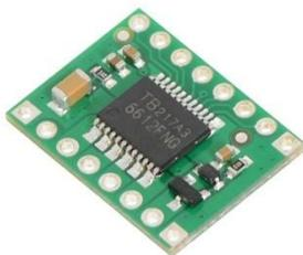
Фиг.16. TB6612FNG Dual Motor Driver Carrier [28]
