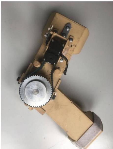
Фиг.2. Прототип на орезката с монтирани актуатор и редуктор
