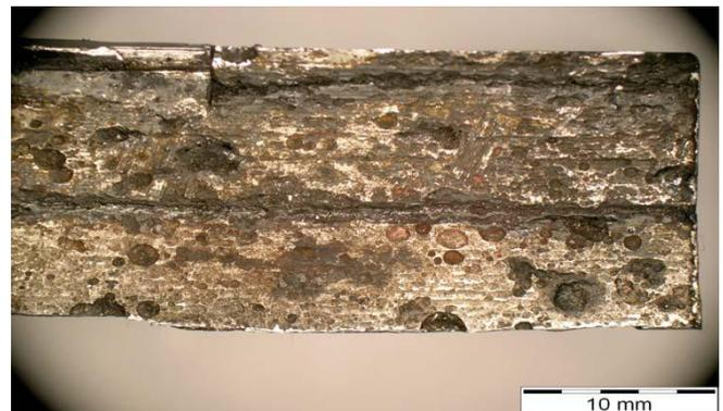
Фиг.5. Разрез на темплет на вътрешна повърхност на заварено съединение с дефекти
