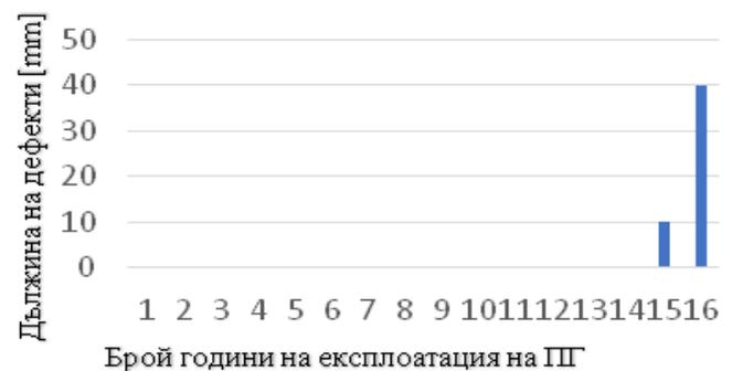
Fig.7. Периоди на зараждане на дефекти в заварените съединения между колектори на парогенератори и щуцери Ду 1200 на главни циркуляционни тръбопроводи.
