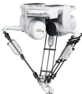
Фиг.23. FANUC M-3iA/6A Delta Robot
