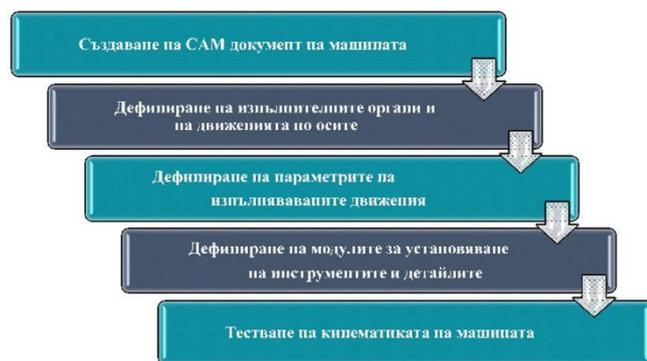
Фиг. 3 Алгоритъм при разработване на кинематични модели на машини
