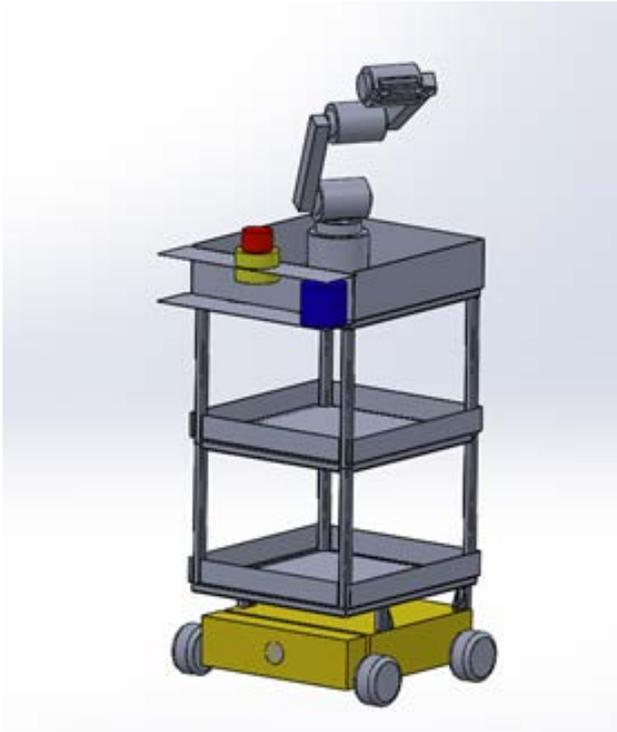
Фиг. 3. Роботизираната модулна транспортна система
