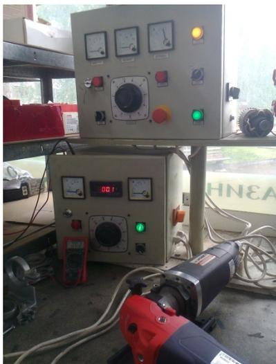
Фиг.1 Стенд за изпитване и изследване на ръчни електроинструменти
