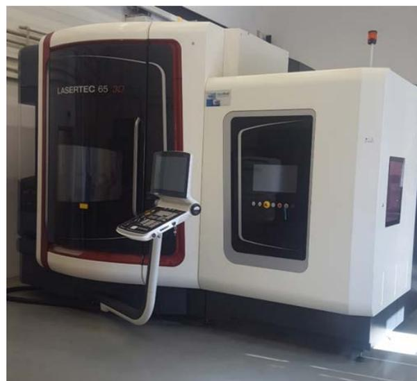
Фиг. 3. Хибридна система DMG-Mori Lasertec 65 3D
