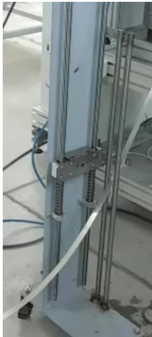
Фиг. 4. Компенсатор: функцията се изпълнява от два успоредни водача на лентата, осигуряващи относителна фиксация и датчик за дистанция, управляващ устройството за развиване.
