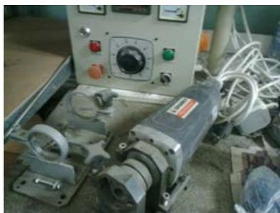
Фиг. 4. Стенд за изпитване и изследване на електроинструменти. Товарно устройство
