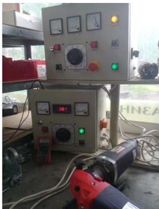
Фиг. 5. Стенд за изпитване и изследване на електроинструменти. Реализация
