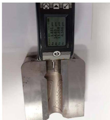
Фиг. 6. Измерване на грапаост на повърхнини от формообразуващ инструмент
