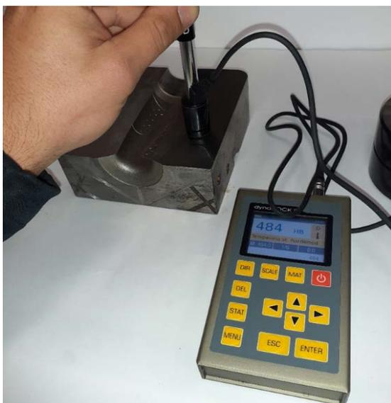
Фиг. 8. Измерване на твърдост на повърхнини от формообразувач инструмент
