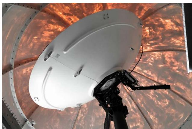
Фиг. 4. Orbit Gaya антена на станция Плана – вътр. част (Източник: <https://www.endurosat.com/services/digital-ground-station/>)
