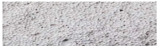
Фиг.1. Структура на газобетон
