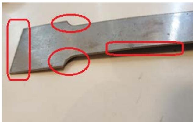
Фиг. 4. Пробно тяло с усенъци (преди заточване на пресата)
