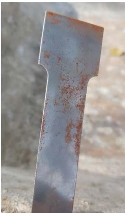
Фиг. 5. Пробно тяло без усеньци (след заточване на пресата)
