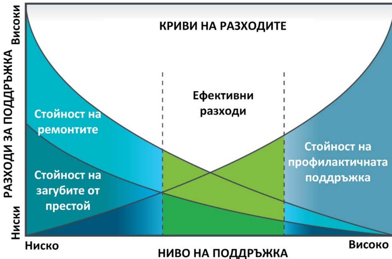
Фиг.1 Криви на разходите свързани с експлоатацията на една производствена система
