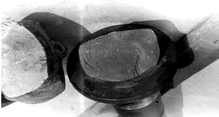
**Фиг.1.** Разрушена колянова ос от стомана 38ХС след дълги контролни изпитания от 3800 км пробег на изделието
