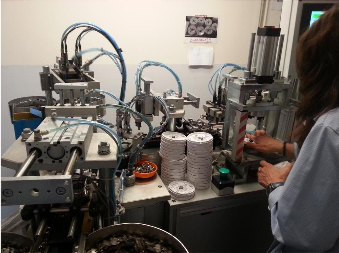
Фиг. 1. Снимки от автоматична машина за бързо асемблиране на основи за датчици
