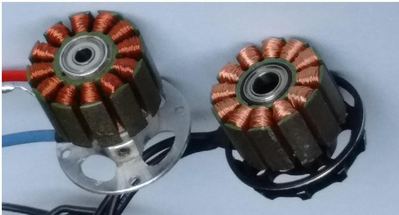
Фиг. 2 Статор на безчетков постояннотоков двигател
