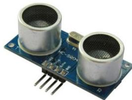
Фиг. 4. Ултразвуков датчик HC-SR04
