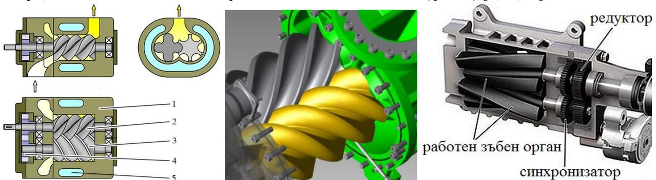
Фиг. 6 ТЗМ под формата на работен орган в устройството на винтовите компресори
