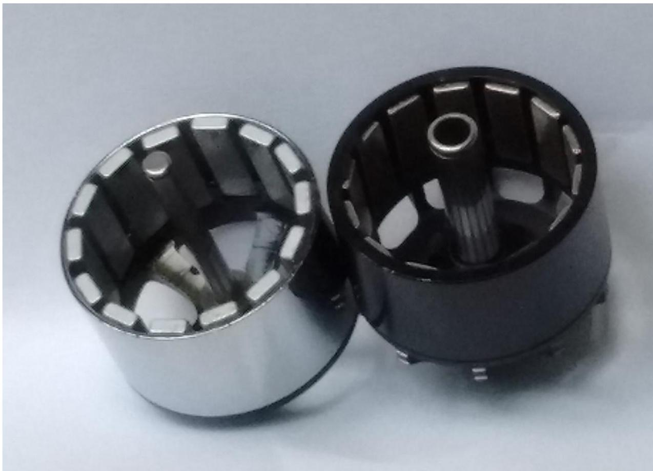
Фиг.1 Ротор на безчетков постояннотоков двигател
